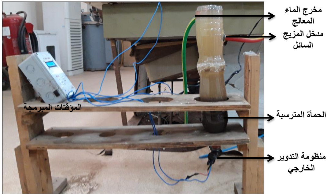
الشكل (4) صورة لحوض الترسيب
